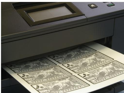
[左] 家庭用インクジェットプリンターでの印刷などによって、簡単に電子回路が作成可能。
