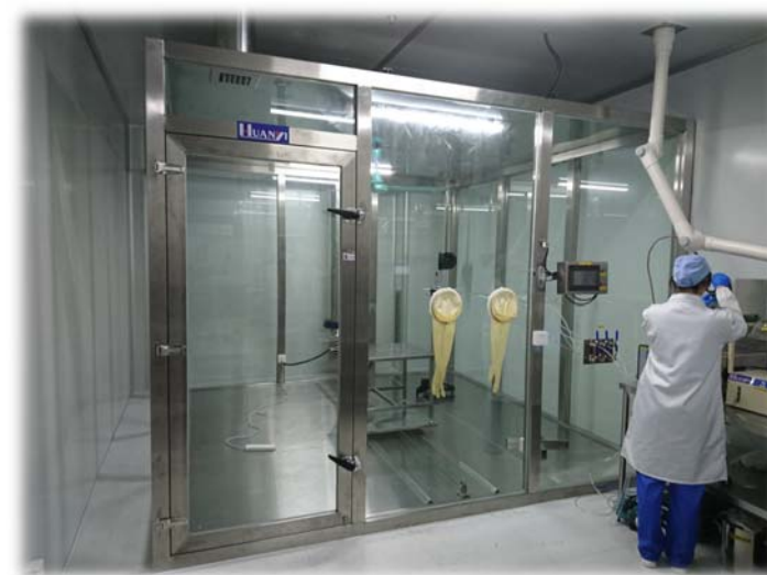
フィルター中国国家標準規格評価装置 (中国子会社に設置)
